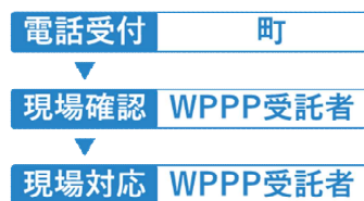
図 4-3 管路の緊急対応業務の対応フロー
