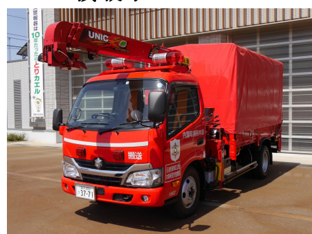
クレーン付資機材搬送車
