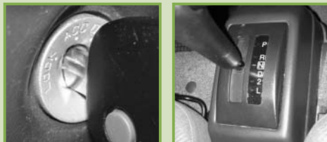
アイドリングストップ時はキーをACCに。完全に停車した後、シフトレバー<Nレンジ>へ、エンジン再始動の時は当然STARTまで回します。
