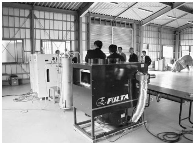
水と少量の電気・化石燃料を用いる低炭化水素酸素発生装置
