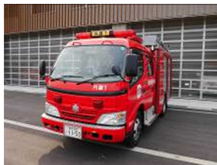
普通消防ポンプ自動車 年式 平成21年式 ポンプ級別 A-2 積載水 800L
