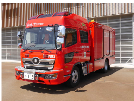
災害対応特殊水槽付消防ポンプ自動車 年式 平成31年式 ポンプ級別 A-2 積載水 2,100L
