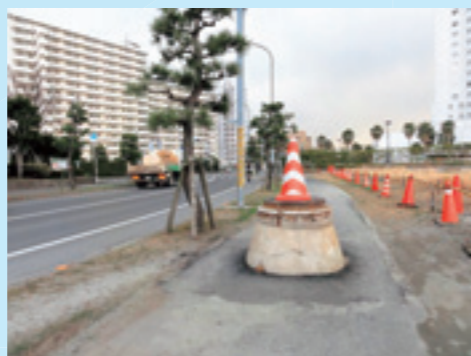
マンホールの浮き上り（東日本大震災） 写真：独立行政法人土木研究所
